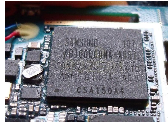
Puce ARM Exynos sur le smartphone Nexus S de Samsung.
